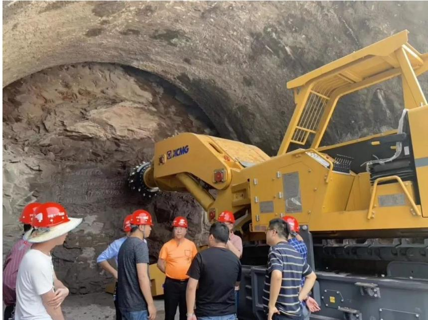
**XTR4/180**隧道掘进机液压系统主要由油缸（包括：切割头升降油缸、切割头回转油缸、铲板油缸、后支承油缸、一运张紧油缸、二运升降油缸、二运回转油缸）、马达（包括：行走、星轮、一运）、泵站、控制阀块以及辅助元件等组成。主要液压元件均采用国际知名品牌。
